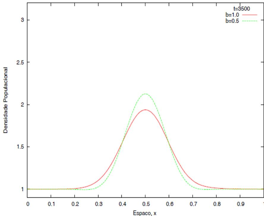
Figura 4: Comparação entre as soluções com  $\beta = 1.0$  (difusão pura) e  $\beta = 0.5$  (difusão com retenção).
